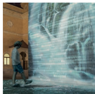
Proiezione immagine lineare con gobos dicroico su porta accessori.
