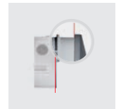
Micro falda in grado di coprire perfettamente lo spessore della controcassa
